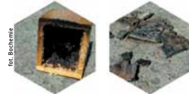
Po lewej drewno zaimpregnowane preparatem BOCHEMIT® Antiflash , po prawej – nieimpregnowane.
